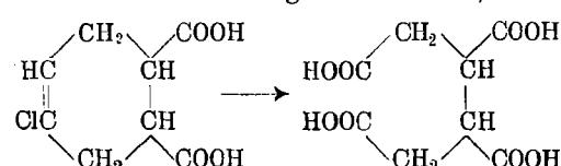
dessen weitere Oxydation Butan-tetracarbonsäure ergibt. Diese beiden Umsetzungen beweisen die Konstitution des Chloroprens.
